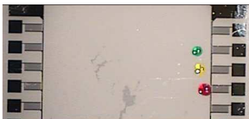
Dispositif de déplacement de gouttes sur une surface utilisant des transducteurs à ondes de surface
