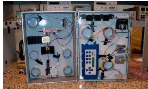
Récepteur/décodeur par chaos multi-GHz.
