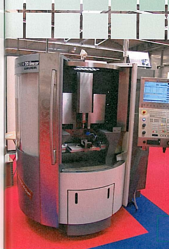
DMG Sauer DMC20 Linear Ultrasonic, fresatrice con finitura a ultrasuoni.
