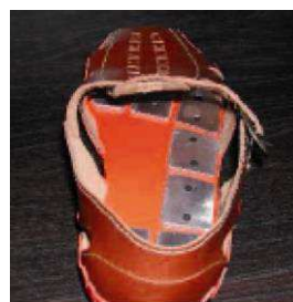
Chaussure instrumentée. Accès à la répartition des contraintes.
