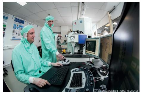
Station de nanomanipulation (MEB+FIB robotisé)
