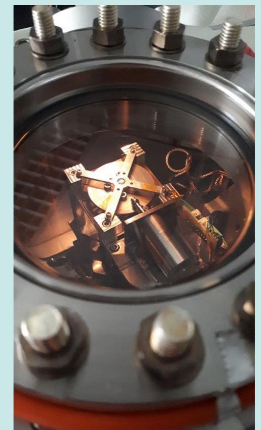
Tribomètre bille/disque pour étude tribologique sous environnement ultravide
