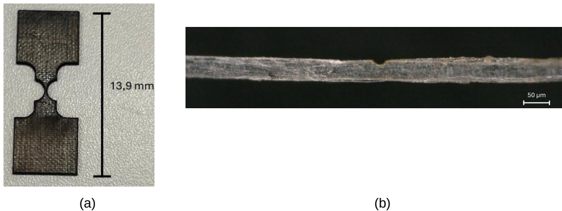
Figure 1 : (a) Micro-échantillon de composite unidirectionnel lin-epoxy obtenu par usinage laser. (b) Fibre de lin entaillée par ablation laser.
