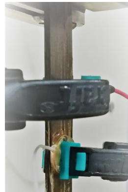
Essai de traction sur éprouvette lin/epoxy instrumentée avec un capteur CMUT
