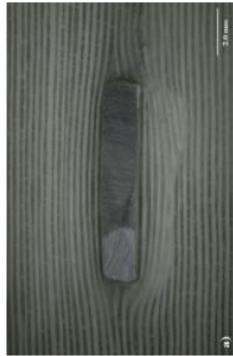
Exemple d'insert dans les plis d'une structure composite
