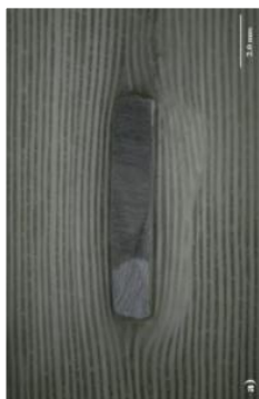
Exemple d'insert dans les plis d'une structure composite
