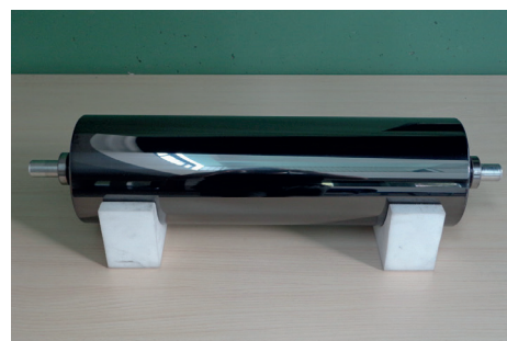
Tambour d'impression magnétographique revêtu d'une couche de DLC (client: Nipson Tecnology)
