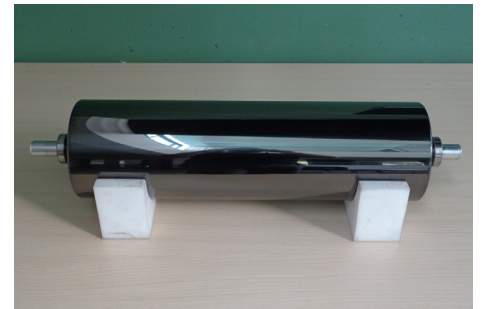
Tambour d'impression magnétographique revêtu d'une couche de DLC (client : Nipson Tecnology)
